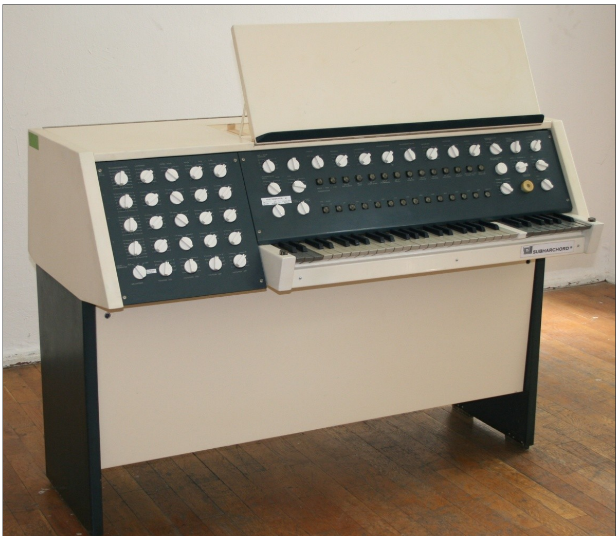
Bild 9.48. Der Elektronische Klangerzeuger „Subharchord 2/3“, O 101 Nr.02/68, der erste Hybrid-Synthesizer, vollständig restauriert. (Foto: Georg Geike, 2007).
