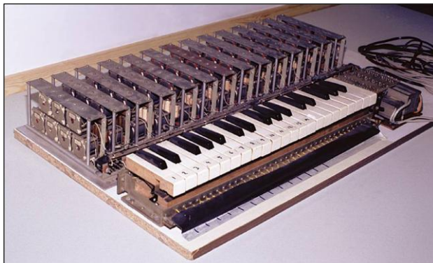
MEL-Filterbank, angesteuert mittels MIDI-Controller, im AdK-Studio (Foto: Archiv Steinke)
